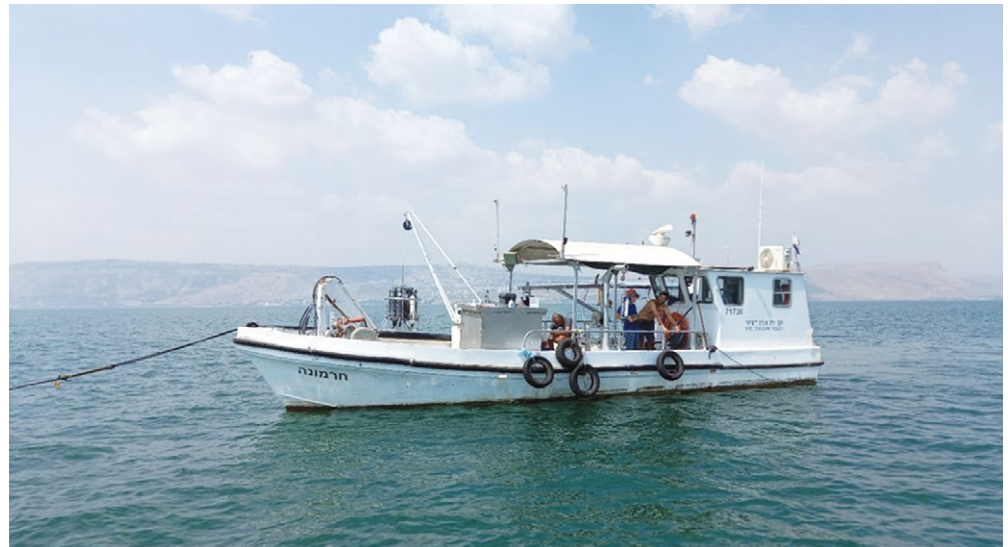
איור 8: ספינת 'חרמונה' בפעולה - הורדת מתקן הרוזטה למים.
