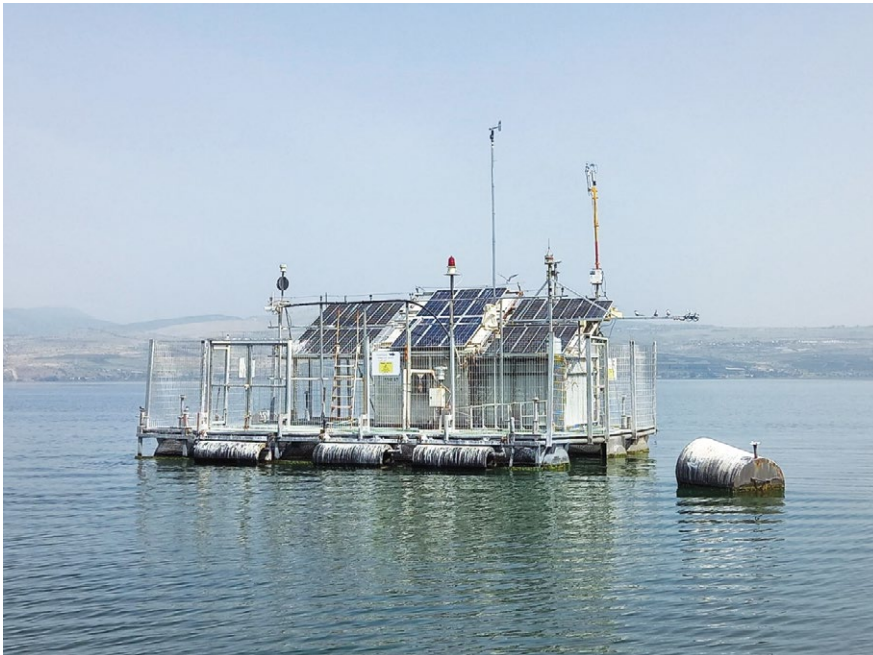
מימין - איור 1: מפה בתימטרית של הכינרת ותחנות הדיגום של תוכנית ניטור הכינרת. משמאל: איור 2: Ecoraft - דוכרה הממוקמת בנקודה העמוקה ביותר באגם (תחנה A) ומבצעת דיגום אוטומטי ברזולוציה גבוהה.
