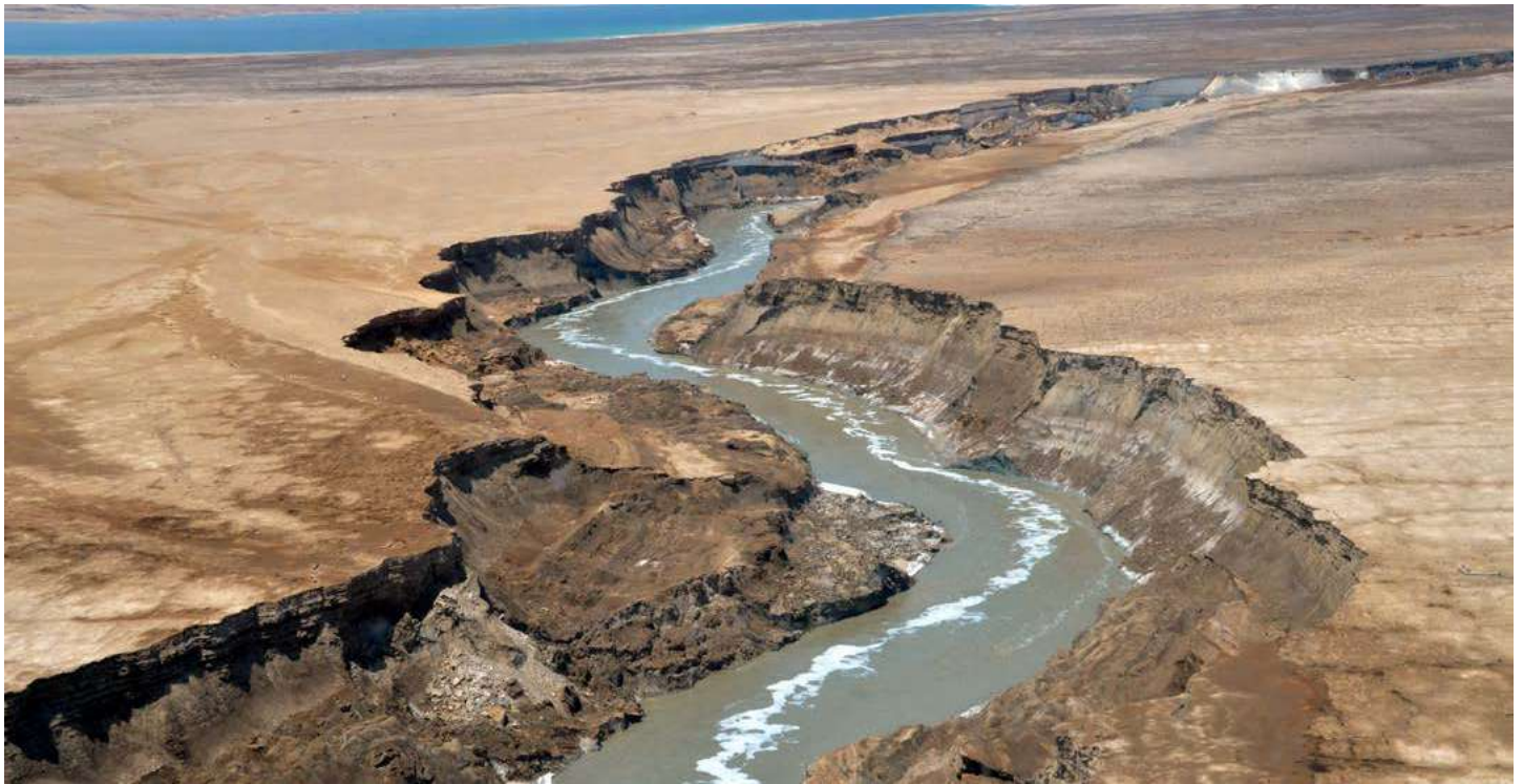
תצלום ממסוק של התחתרות נחל הערבה בין בריכות האיזוי לים המלח. בעקבות הזרמת התמלחות הסופיות ממפעלי ים המלח הישראליים והירדניים, הספיקה בערוץ היא הגבוהה ביותר מבין כל יובלי ים המלח, כולל נהר הירדן.
